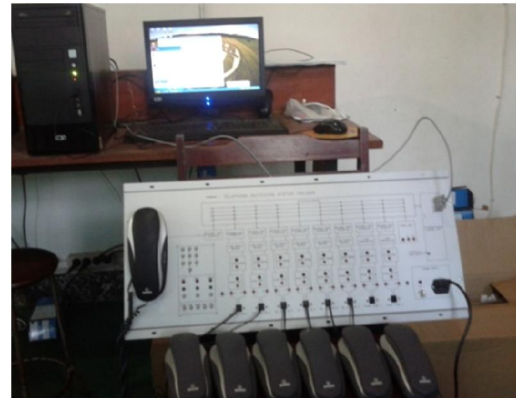
Gambar 2. Konfigurasi Sistem Switching Telephone Trainer , 6 set pesawat telepon dan power supply .
